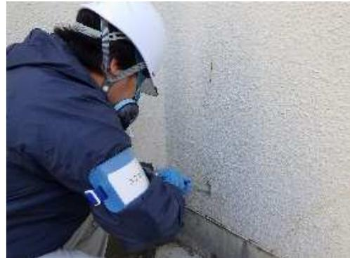
写真2.1 試料採取道具および試料採取状況例
