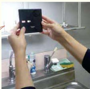
残留塩素のチェックは、試薬を水道水に入れ、発色した色の濃さを色見本と比較します。
