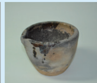
るつぼ 高温を利用して金属をとかす耐熱容器。
