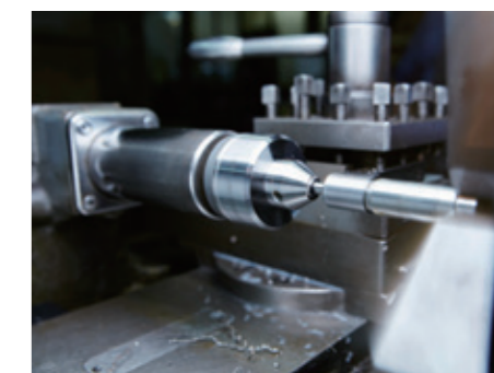
極小単位の精度を出せる「先端取替式」技術
