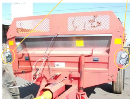
後部反射器及び灯火器類の設置例
