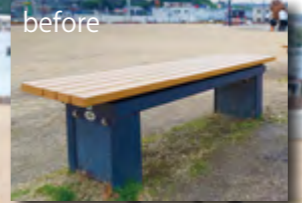
① 4隅のボルトを外し、座面を持ち上げて外す(市が管理する鍵が必要)。
