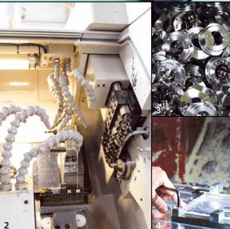
1. 自らトップセールスを行い積極的に改革を進めている小寺社長 2. 部品が摩擦で高熱にならないよう油を注ぎながら加工する装置 3. ②の装置で精密に加工された部品 4. わずかな誤差も出さないよう日々調整される機器
