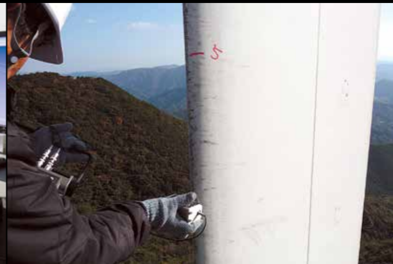
▼風力発電のプロペラをセンサーで検査
